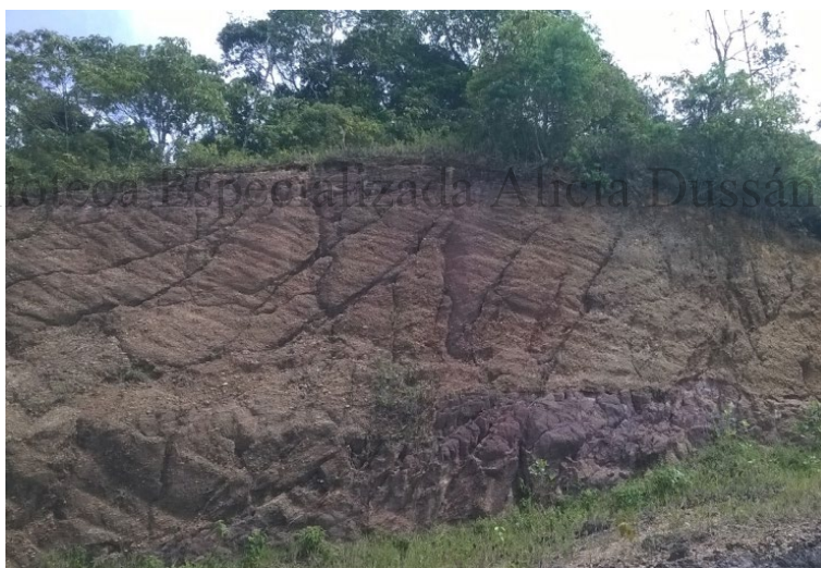
Fotografía 21. Áreas de afloramiento de material rocoso parental y/o fuerte pendiente descartadas para la realización de pozos de sondeo.
