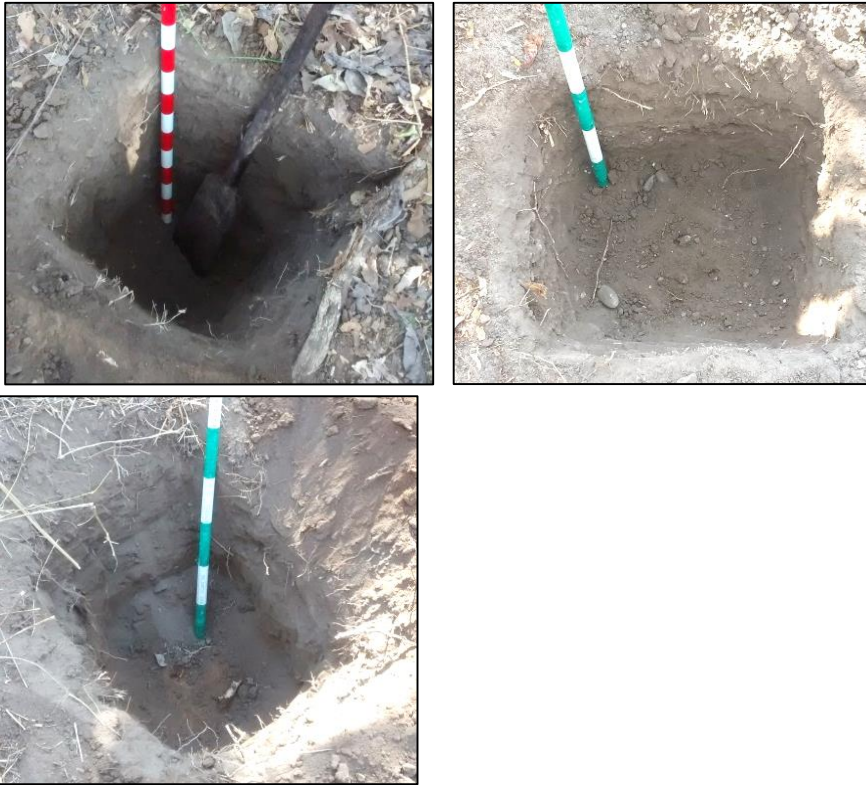
15 Fotografías No. 28, 29 y 30: Sondeos L11, L12 y L13 realizados en sector Norcentral del polígono. En L12 y L13 se observa presencia de material rocoso desde la superficie, imposibilitando la profundización del sondeo.
