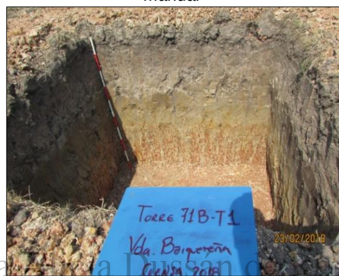
Fotografía 88 Registro perfil estratigráfico Torre 71-B
