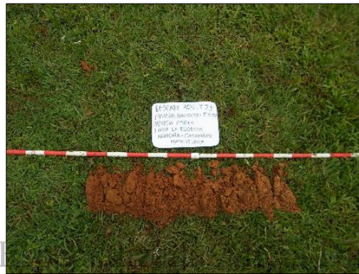
Fotografía 43 Muestra de suelo de la prueba de barreno T33. Todas representan un comportamiento homogéneo a partir de los 50cm de profundidad
