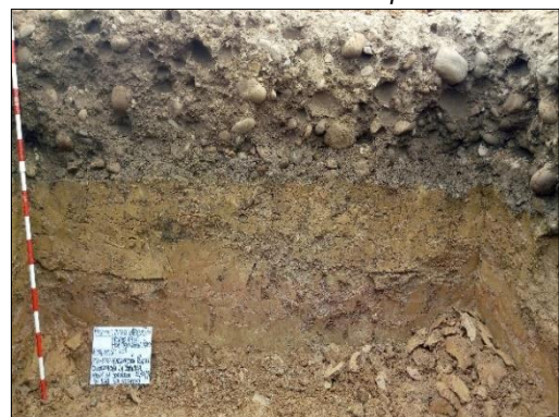
Fotografía 61 Perfil estratigráfico a 1,7m en la zona de pórticos. Nótese en los primeros 70cm la capa de crudo de río
