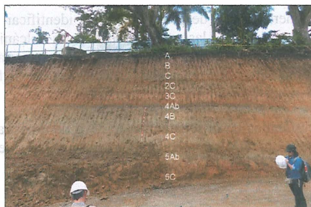
Fotos 105 y 106: Izquierda: Detalle del corte que mira hacia el Oeste. Se observa una posible falla, visible en la ruptura y escalamiento del estrato gris oscuro. Derecha: Caracterización pedoestratigráfica donde se proponen dos paleosuelos (AB) y litoestratigráfica en 5 estratos.
