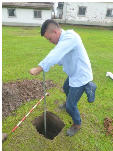
Fotografía 24. Excavación prueba de barreno. Fuente: INGEDISA S.A. 2018.
