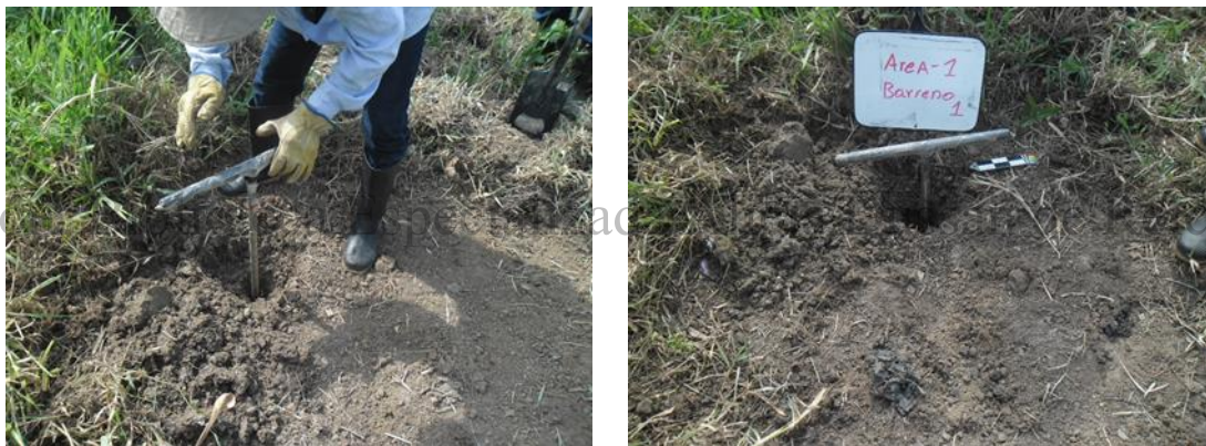
Fotografía 17 Registro de la prueba de barreno
