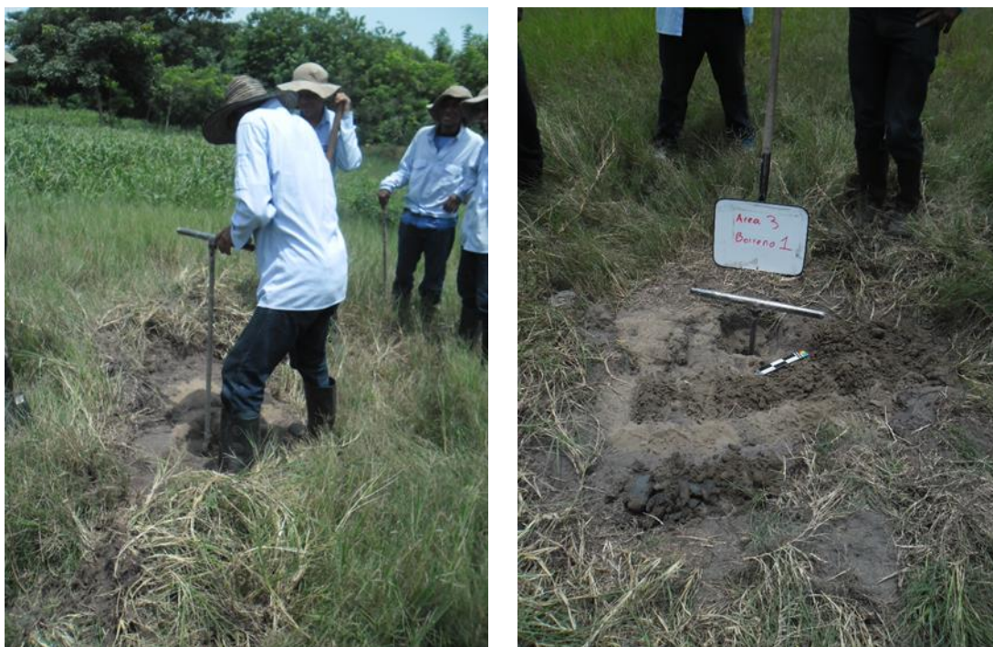
Fotografía 43 Prueba de barreno en el área 3
