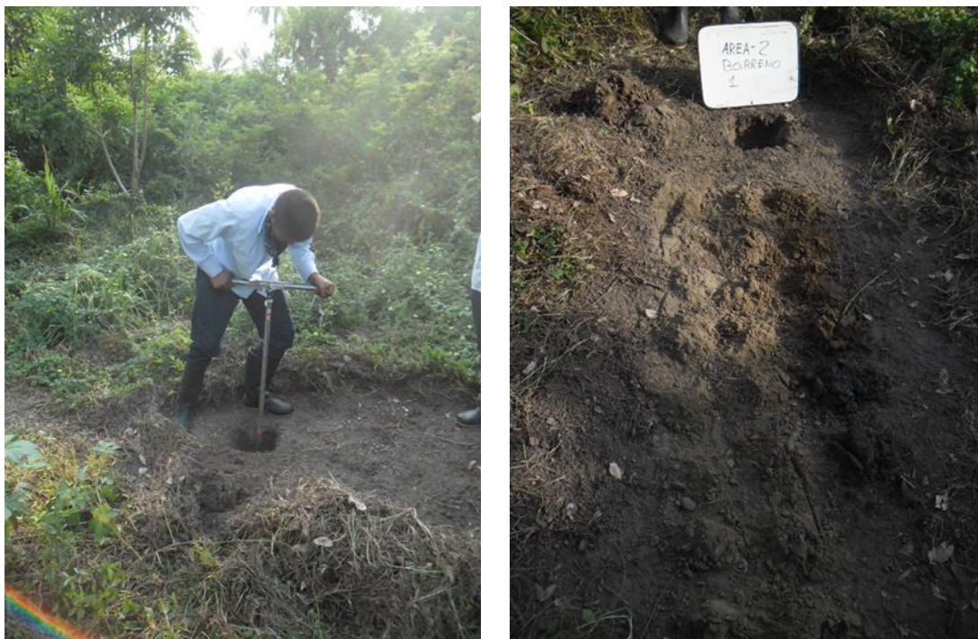
Fotografía 34 Prueba de barreno 1 realizada en la isla Rondón
