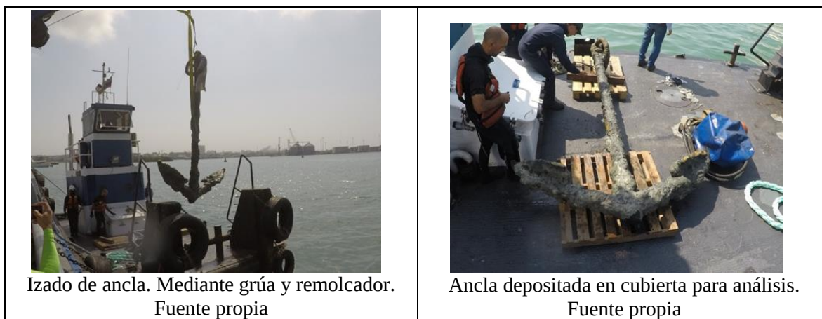
Figura 17. Maniobra de izado de ancla.
