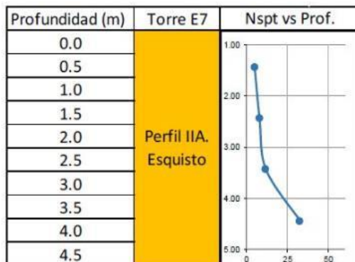
Figura 5.14 Perfil estratigráfico geológico torre E7
