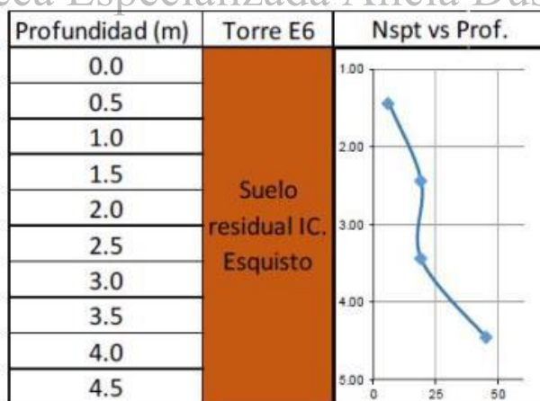
Figura 5.30 Perfil estratigráfico geológico torre E6
