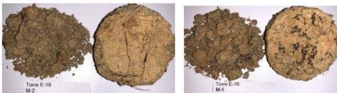
Fotografía 5.25. Muestras del sondeo geológico – UIA 16
