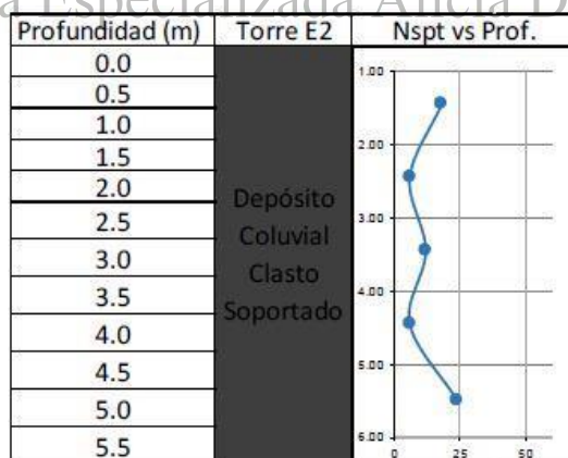
Figura 5.6 Perfil estratigráfico geológico, torre E2
