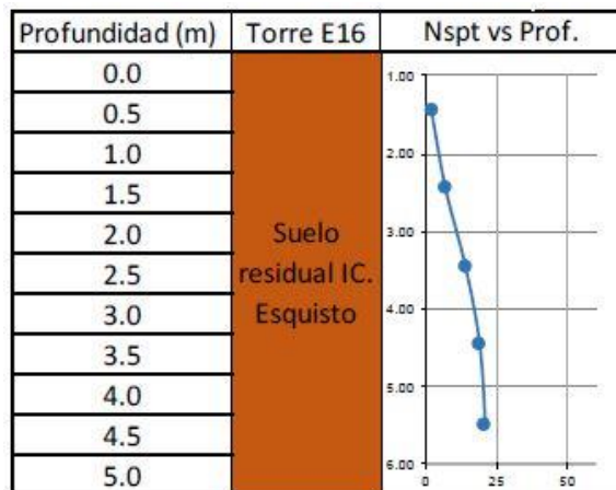
Figura 5.26 Perfil estratigráfico geológico Torre E16
