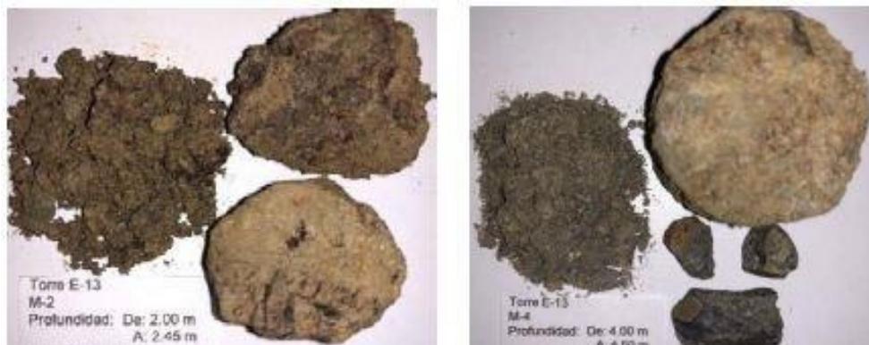
Fotografía 5.21. Muestras del sondeo geológico – UIA 13
