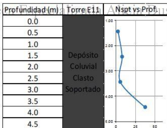
Figura 5.34 Perfil estratigráfico geológico Torre E11
