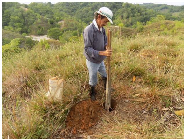
Fotografía 3. Realización de pozo de sondeo.
