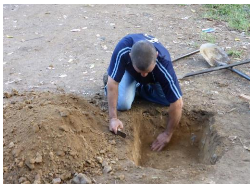
FOTO 16. EXCAVACIÓN DE POZOS DE SONDEO UMA 1- AREA 1
