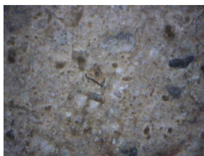
Figura 11. Fotomicrografía de fragmento (350x), se observan los granos de cuarzo y mica negra.
