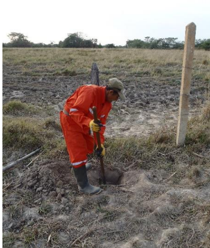
Fotografía 30. Apertura de pozos de sondeo
