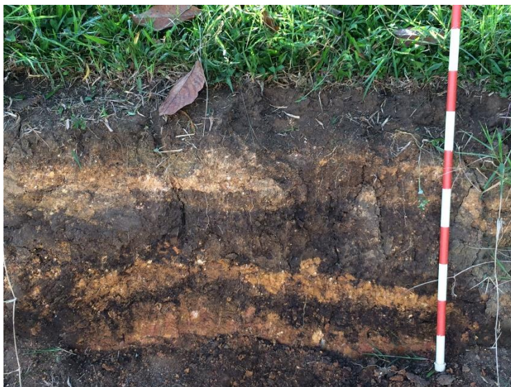
Foto 93. Perfil Modal de Suelos 2- Cotas altas del predio entre los sectores 1 y 2. Presenta una capa orgánica de 20 cm aproximadamente, seguida por 5 capas de llenos compactados, con una matriz tipo arcillosa. Además, presenta rocas de diferentes dimensiones, vidrios, tejas y baldosas. Al revisar los perfiles de dicho sector se confirma la acumulación constante de escombros y basuras a las que ha sido sometido el predio desde antes del inicio del Proyecto Inmobiliario Ámsterdam.
