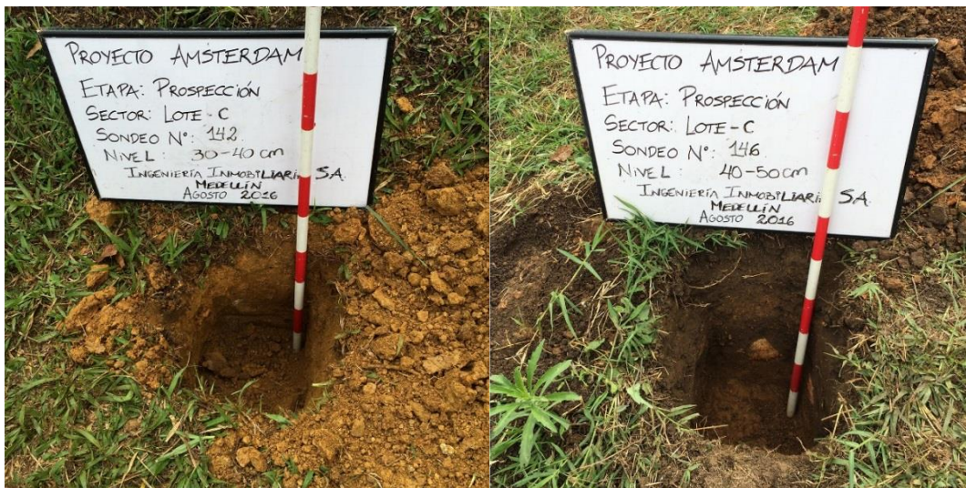
Fotos 102 y 103. Pozos de sondeo excavados hasta una profundidad máxima de 60 cm, en los cuales se puede ver la escasa capa orgánica con menos de 20 cm de grosor, y una capa estéril de color naranja justo debajo, que algunas veces presentó rocas de diferentes tamaños. Es posible que esta estratigrafía y resultados sea producto de las numerosas intervenciones y llenos antrópicos que ha sufrido el predio en los últimos años.
