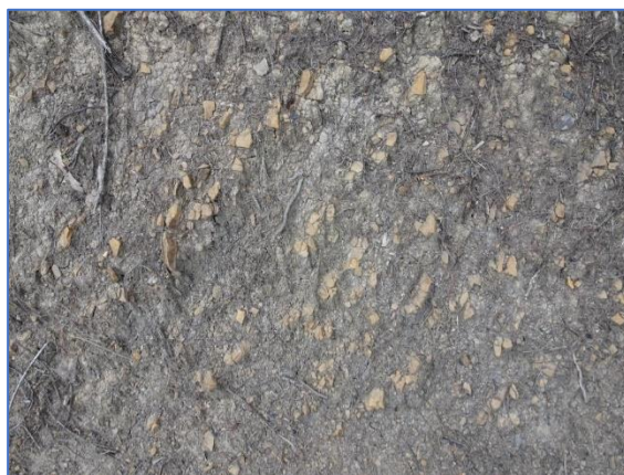
Fotos N°23 y 24. Vía con corte de talud donde se observan las areniscas incrustadas en una matriz arcillosa.
