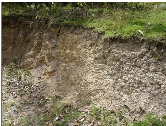
Fotos N°91 y 92. Antigua bocamina en derrumbe. Corte de perfil donde se aprecia una delgada capa orgánica debido a la escarpada topografía.
