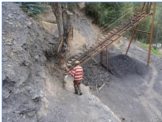
Fotos N°55 y 56. Corte de talud con areniscas en matriz arcillosa. Descenso hacia la tolva y área de carga.
