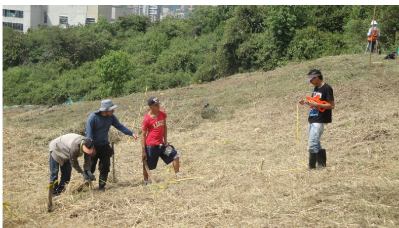
FOTO 4. DEMARCACIÓN GRILLA DE POZOS DE SONDEO SECTOR SUR
