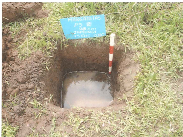
Foto 1. Imagen del pozo de sondeo 2, el nivel freático aparece a 35 centímetros.
