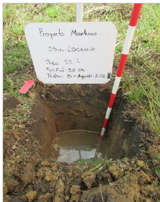
FOTOGRAFÍA 34 POZO CON NIVEL FREÁTICO A 40 CM.
