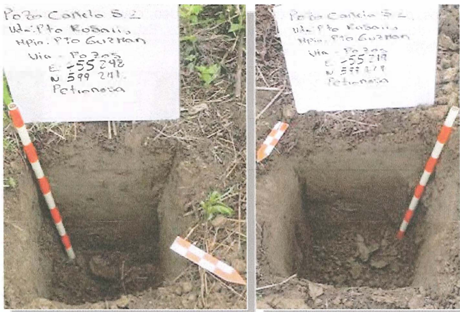
Fotografía 6-20. Municipio de Puerto Guzmán, vereda Puerto Rosario locación Canelo Sur 2. Pozos de sondeo excavados en el trazado de acceso a esa locación.
