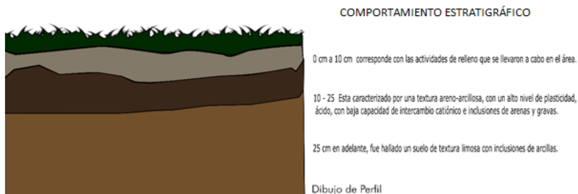
Figura 4-1 Diagramación del comportamiento estratigráfico observado en los pozos de sondeo
