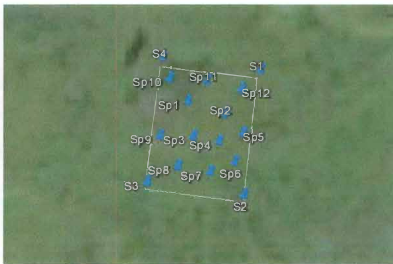
Figura N° 14. Distribución de los pozos de sondeo excavados en el sitio de interés S.
