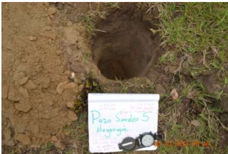
Lámina 6. Pozo de sondeo No. 5.
