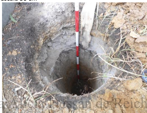
Imagen 45 Perfil postes alumbrado Se presenta un horizonte O superficial muy delgado, luego el horizonte gris característico de la zona, el horizonte argílico y las sucesivas capas de arcillas y arenas. Tamaño de la escala 100 cm
