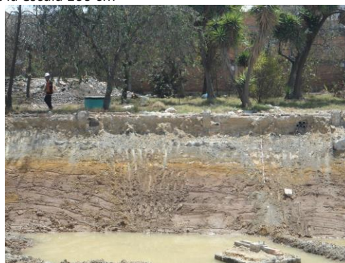
Imagen 47 Perfil sur excavación Por su parte, un perfil bajo las placas de concreto muestra la intervención con rellenos y adecuaciones que alteran la estratigrafía hasta el horizonte gris. No se observa horizonte argílico. Tamaño de la escala 250 cm
