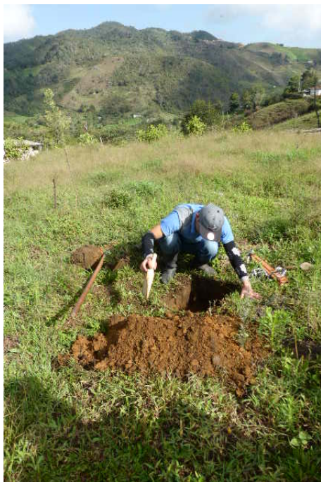
FOTO 11. REALIZACIÓN POZOS DE SONDEO (UMA 2-UMG 1)
