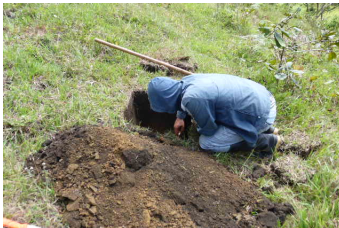
FOTO 5. REALIZACIÓN POZOS DE SONDEO (UMA1)
