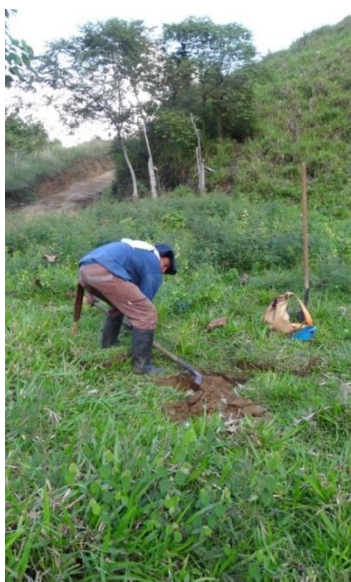
FOTO 2. REALIZACIÓN POZOS DE SONDEO. UMA 1.
