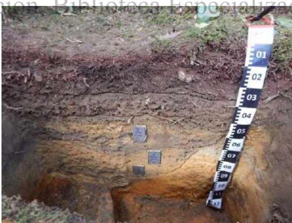
Cajas para toma de muestras de sedimentos
