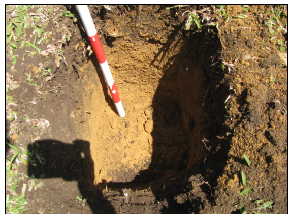
Foto 28. Detalle estratigráfico PS35.
