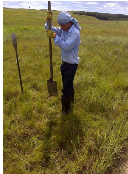
Fotografía 20 Apertura de pozos de sondeo en el Zodme
