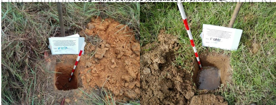
Fotografía 8. Sondeos realizados en el Tramo 1.
