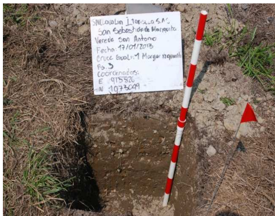
Fotografía 4-3 Pozo de sondeo No. 3. Gualí 1 margen izquierda
