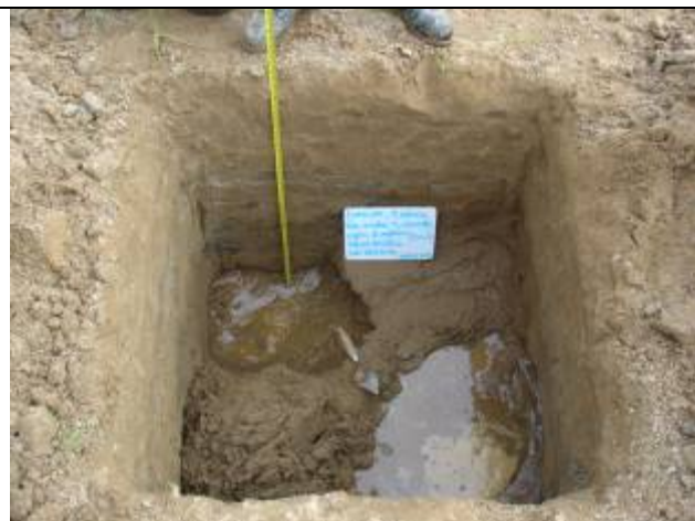
Fotografía 7. Pozo de sondeo 4. Nivel Freático
