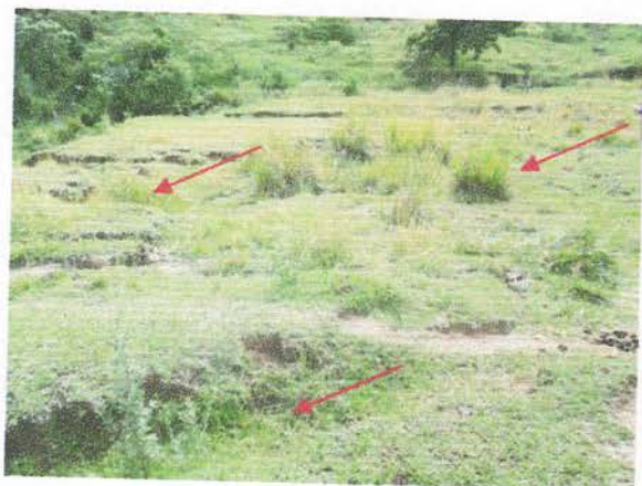
Foto 34 y 35. Hundimiento del terreno por filtración de agua en el centro del predio.
