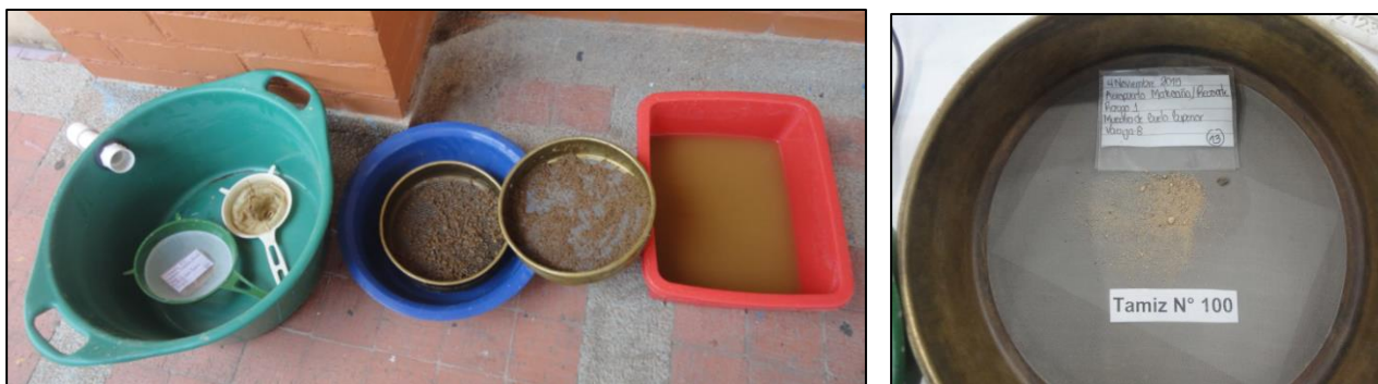
FOTO 32 Y FOTO 33: Utensilios usados en laboratorio para recuperar semillas y carbones contenidos en los suelos. Con el tanque de flotación, tamices y filtros se recuperan semillas y carbones.
