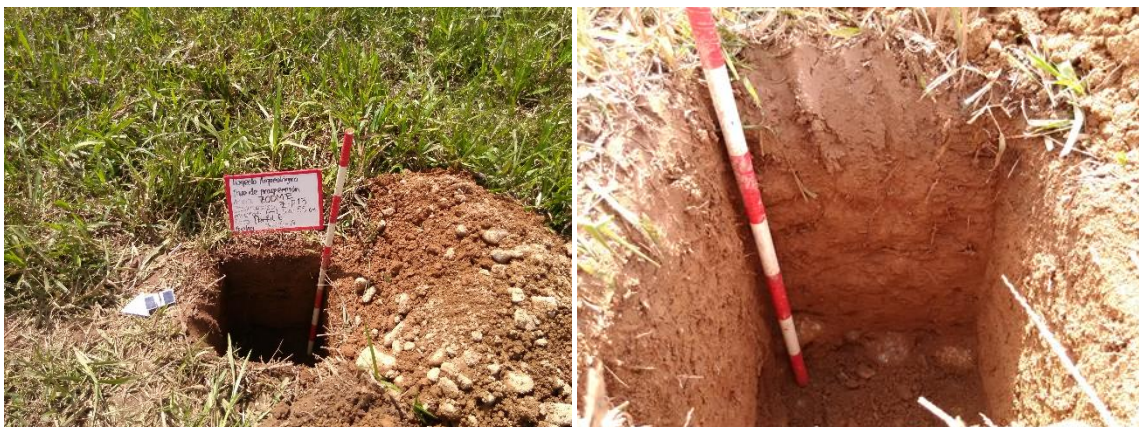
Fotografía 19 Detalle de pozos de sondeo donde se registró un estrato rocoso en el ZODME
