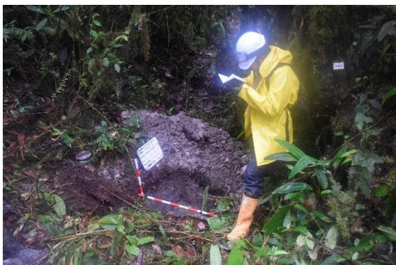
Fotografía 11 Registro estratigráfico de pozo de sondeo
