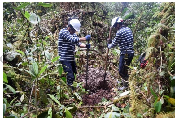
Fotografía 10 Apertura de pozo de sondeo
