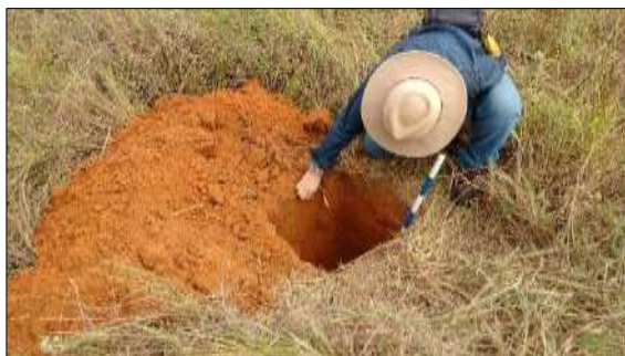
Fotos 5 y 6. Toma de datos y descripción de suelos en campo.
