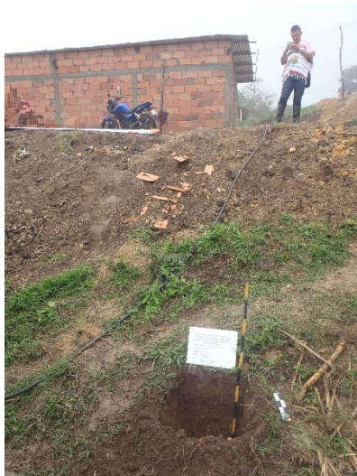
Fotografía 8 Pozo de sondeo MR01 realizado cerca del campamento
