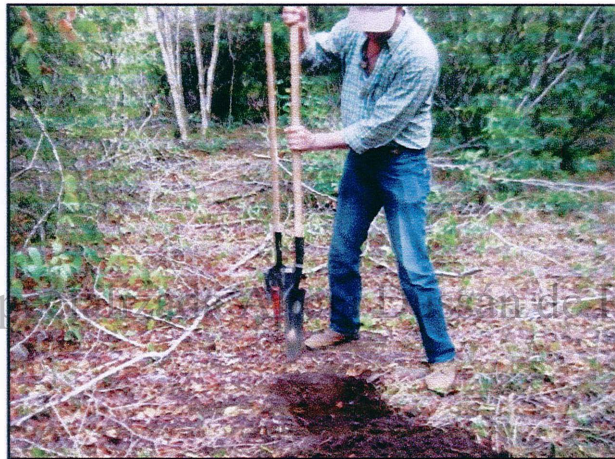
Foto No.2. Realización de sondeos en el Lote del proyecto.
