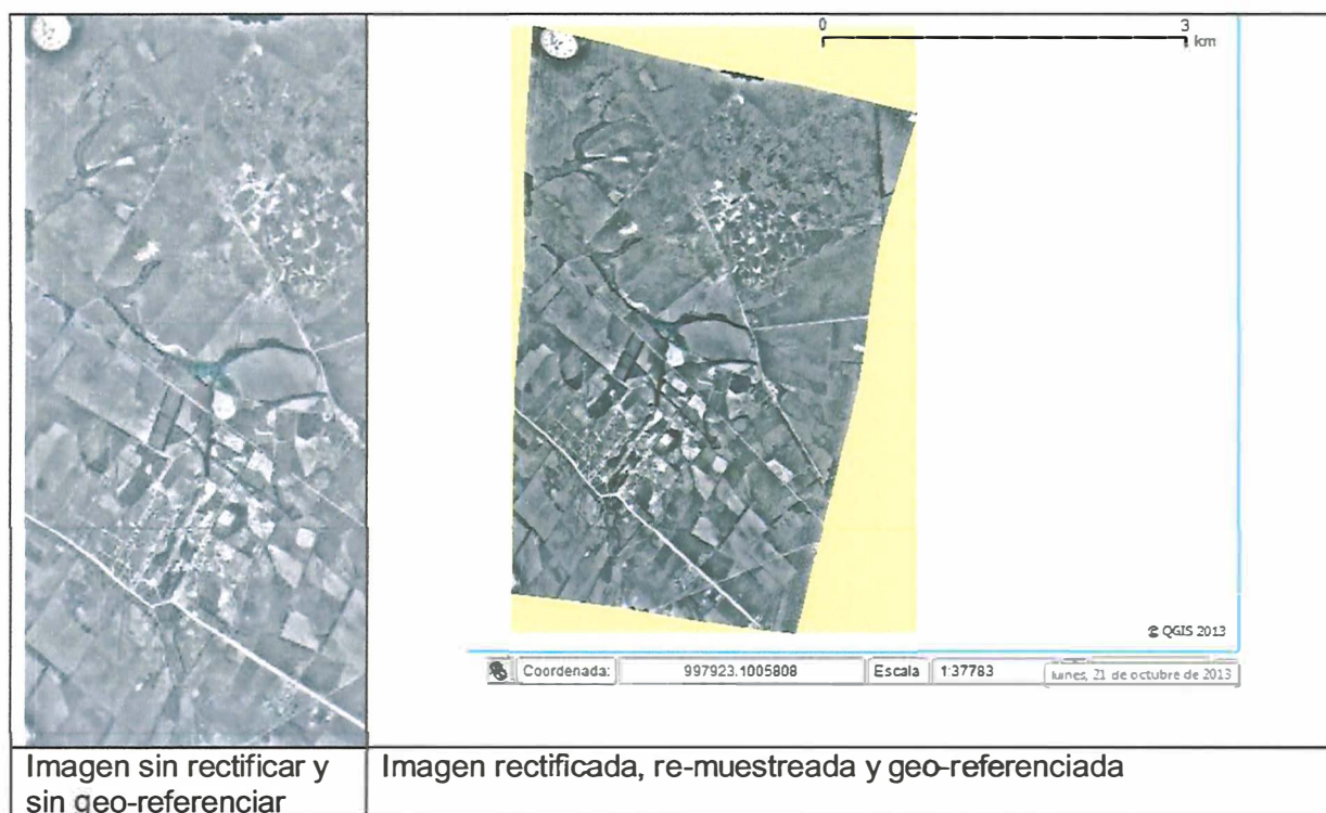
Figura. 31 Comparativo entre las fotografías aéreas fusionadas 15 y 19 (A-27 1:24 38 S-404) sin rectificar (imagen de la izquierda) y rectificadas, re-muestreadas y geo-referenciadas (imagen de la derecha)
