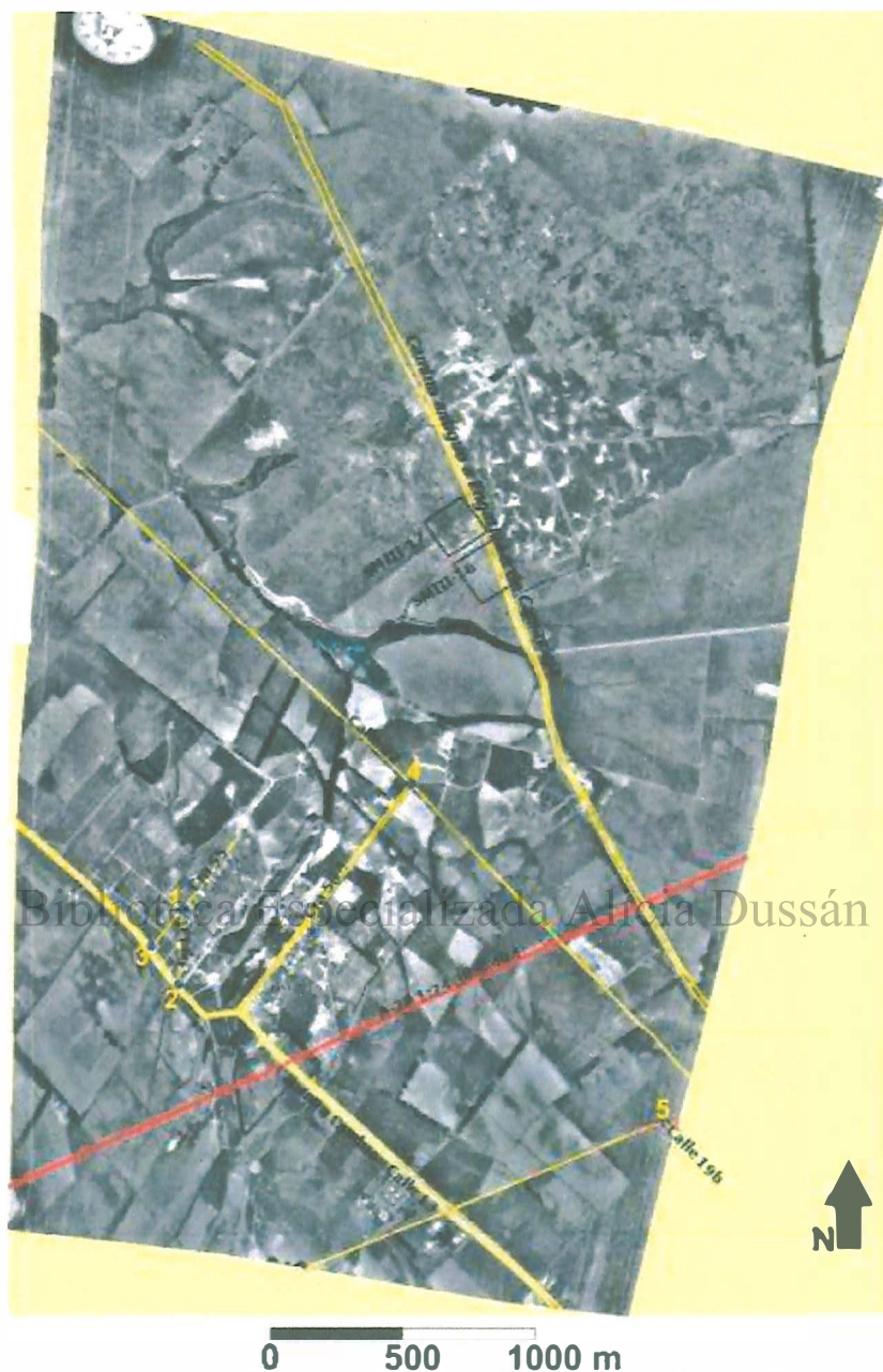
Figura. 32 Puntos de control, sitios y calles digitalizadas en la fotografía aérea rectificadas, re-muestreada y geo-referenciada
