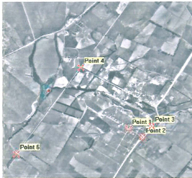
Figura. 30 Ubicación de los cinco (5) puntos de control o de rectificación con coordenadas cartesianas, dentro de pixeles establecidos en las fotografías aéreas fusionados 15 y 19 (A-27 1:24 39 S-404)
