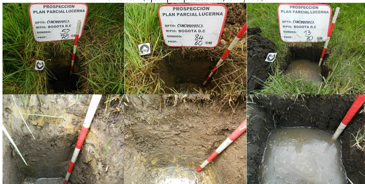
Figura 20. Pozos realizados sobre las zonas inundables del terreno, margen sur oriental (ejemplo pozos 52, 84 y 13).
