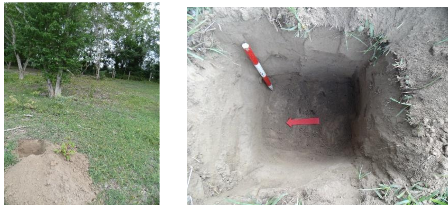
Izquierda: área del pozo de sondeo 4. Derecha: final de excavación pozo de sondeo 4.
