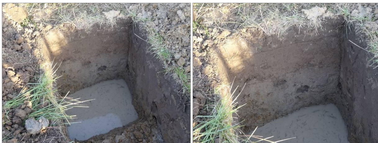
FOTOGRAFÍA 11 Y FOTOGRAFÍA 12 PERFIL ESTE DEL CORTE DONDE AL FINAL SE OBSERVA EL NIVEL FREÁTICO.
