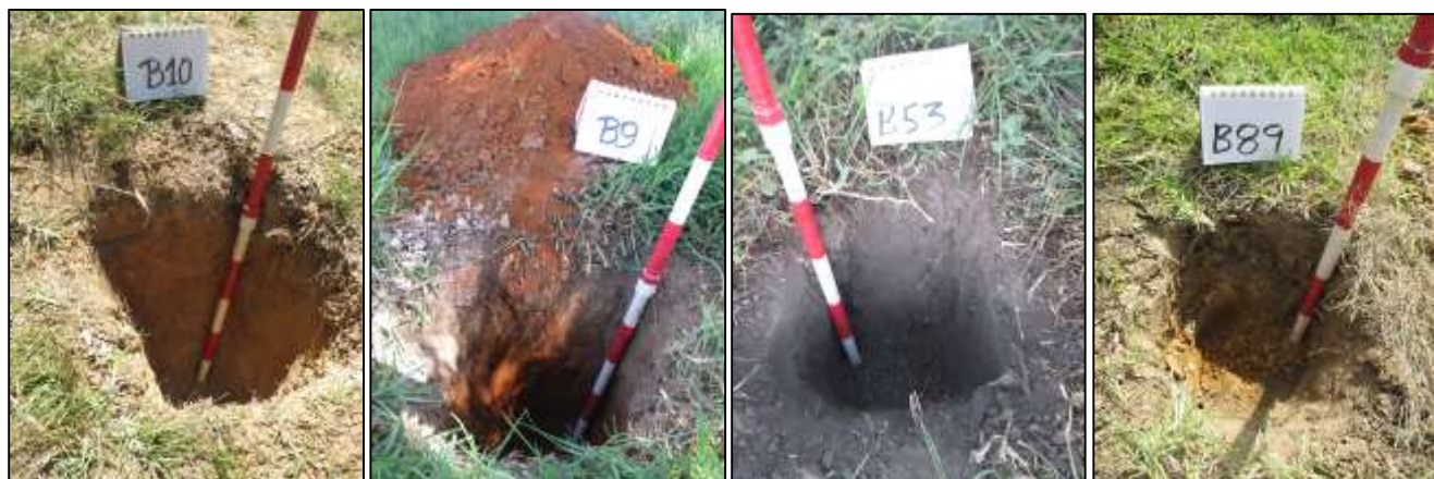
Figura 16. B9, B10: se muestra la variabilidad entre sondeos en la parte baja del lote B (en el ejemplo, arcilla natural y arcilla de relleno ferruginosa). B53: suelos de 30cm en la parte media. B89: roca expuesta en la parte alta.
