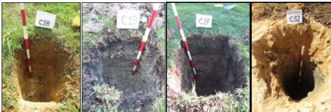
Figura 12. Sondeos en el lote C. C38: arcillas en la mayor parte del lote; C19: área encharcada cerca al acuífero; C17: cancha de fútbol con tierra negra transportada y compactada; C32: cancha de voleypalya con relleno de arena y arcilla de 1,2m de profundidad.
