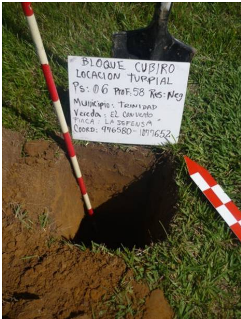
Foto N° 6. Detalle de un pozo de sondeo y de una muestra de suelo procedente de otro pozo de sondeo, se observa que corresponde a suelos arcillosos con manchas de oxidación indicativo de las constantes inundaciones en el lugar.
