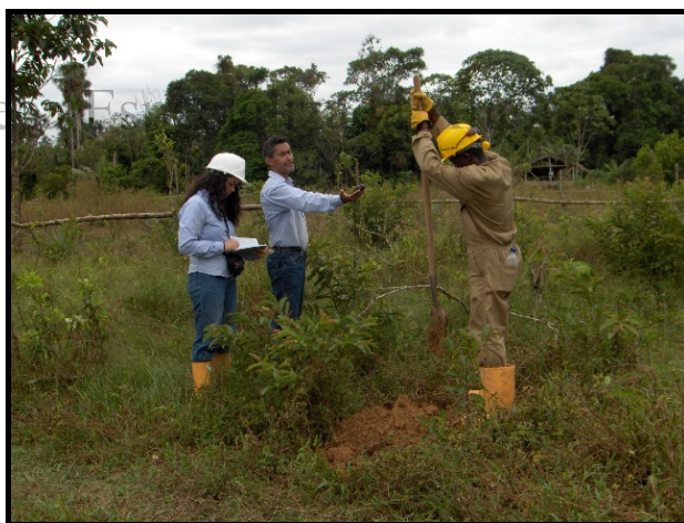
Foto 4.1.1.1 Realización de pozos de sondeo.
