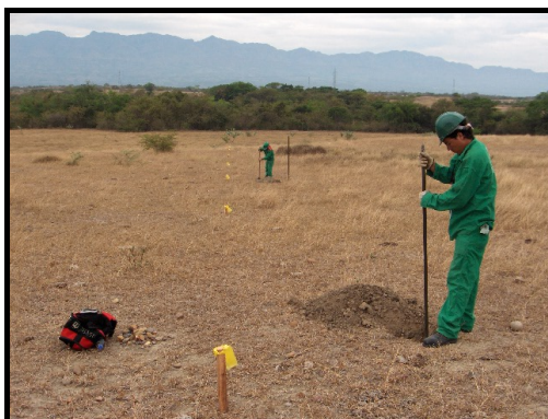
Foto 4.3.1.3 Realización de pozos de sondeo en el área de la locación.
