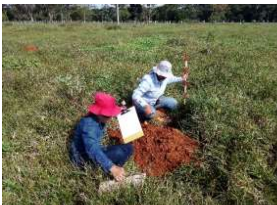
Fotografía 9 Registro de suelos excavados de sondeo. Torre 18.
