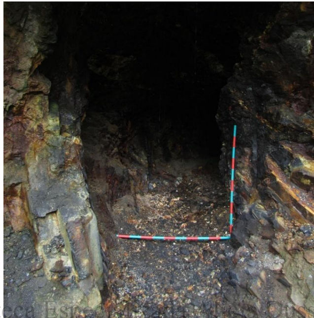
Figura 9 Prueba de minería para la identificación de vetas de esmeralda (Formación Paja)
