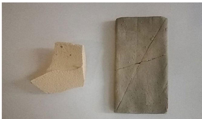
Foto 62. Cambios en la placa por acción de la temperatura. A la izquierda trozo de arcilla secado naturalmente, a la izquierda placa secada con aumento de temperatura
