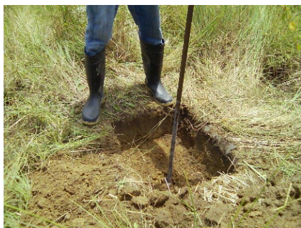
Foto 54. Realización Prueba de Barreno Línea de flujo Subtronal 1E Fase III
