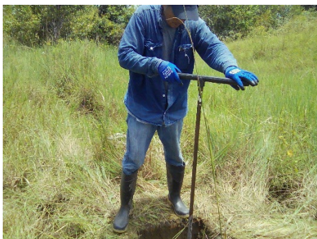
Foto 22. Realización prueba de barreno en área de estudio, línea de flujo Subtronal 1E Fase III
