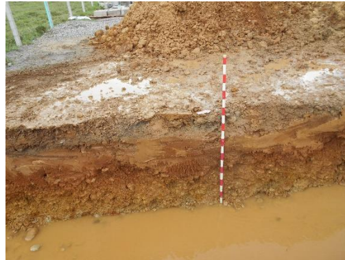
Fotografía 114 Área oeste, detalle de adición de suelos por arrastre (tráfico). Coordenadas E:1046392,17 N:916694,28.
