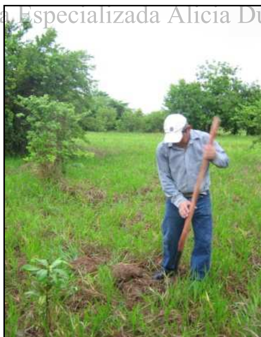
FOTOGRAFÍA 2 APIQUES REALIZADOS EN EL ÁREA DE LLENADERO DE CARGA GLP
