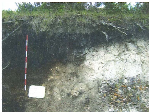
Foto 19. En el Perfil 2 se aprecian varios estratos mal definidos debido a la remoción de suelos y por depositación geológica.
